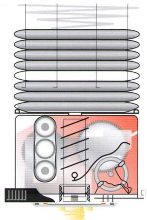
La bomba de pistón de desplazamiento positivo del Sistemas Memolub® bombea grasas y aceites a presiones de hasta **25 bar**. La alta eficiencia del sistema permite bombear grasas a temperaturas de hasta **-15°C**.
